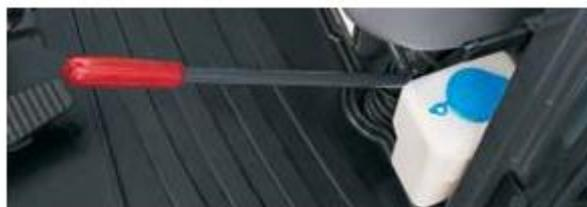
Antes de ligar o motor de uma **escavadeira hidráulica**, é fundamental **assegurar-se de que a alavanca de segurança está na posição "Lock" (Travada)**. Essa verificação é uma medida crucial de segurança para evitar movimentos não intencionais dos componentes hidráulicos enquanto o motor é acionado.
