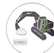
3. Evite operar com o cilindro de escavação no final de curso (completamente aberto) para não danificar as estruturas dos braços e do próprio cilindro.
