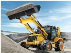
Para elevar e conduzir carga sem derramar o material, retraia por completo a concha depois de enche - La, antes de iniciar a marcha. Durante a elevação a válvula compensadora mantém a concha nivelada evitando o derrame de material.
