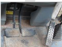
A retroescavadeira está provida de um acelerador de pé, que permite ao operador controlar o regime de aceleração mais adequado aos diversos tipos de trabalho.
