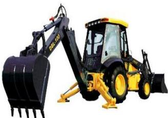
Abaixe as sapatas estabilizadoras para aliviar o peso da traseira. As rodas devem ficar tocando no solo, já que isto fornece a máxima distância entre as sapatas estabilizadoras em um centro de gravidade bem baixo. Se as rodas não tocarem o solo, não só reduz a estabilidade e a profundidade de escavação, como também afetará o rendimento e impõe esforços desnecessários ao motor.
